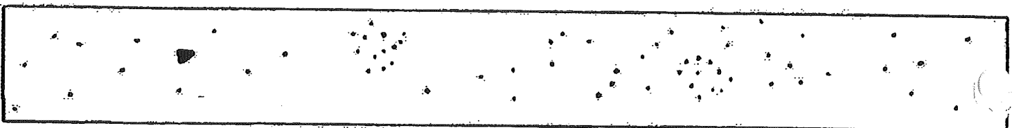
TYPICAL QUANTITY AND SIZE PERMITTED IN 6 in (152.4 mm) LENGTH OF WELDS 1/2 in (12.7 mm) TO 1 in (25.4 mm) THICKNESS QUANTITE ET DIMENSIONS TYPE PERMISES SUR 152.4 mm DE LONGUEUR SOUDEE 12.7 mm à 25.4 mm D'ÉPAISSEUR
