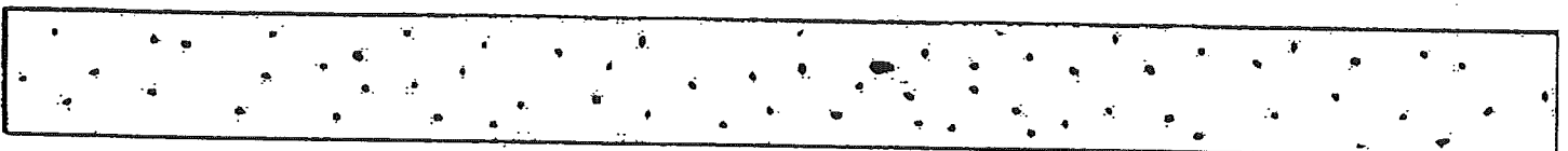
TYPICAL QUANTITY AND SIZE PERMITTED IN 6 in (152.4 mm) LENGTH OF WELDS 1/4 in (6.35 mm) TO 1/2 in (12.7 mm) THICKNESS QUANTITE ET DIMENSIONS TYPE PERMISES SUR 152.4 mm DE LONGUEUR SOUDEE 6.35 mm à 12.7 mm D'ÉPAISSEUR
