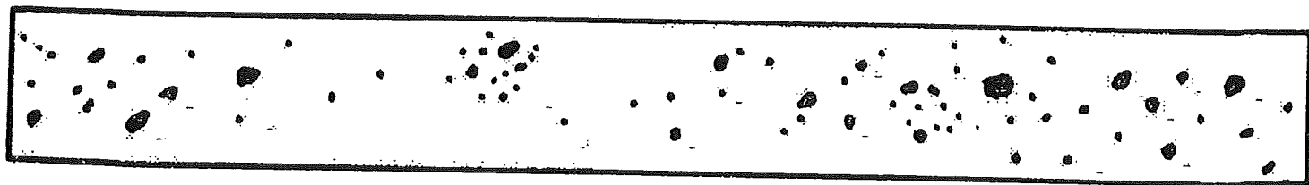
RANDOM ROUNDED INDICATIONS / EXEMPLE D'INDICATIONS ARRONDIES
